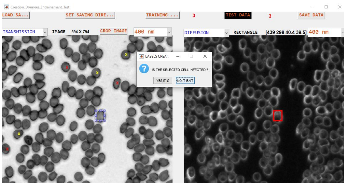
Figure 7. 2 : application de création d'images d'entraînement et de test de cellules sanguines
